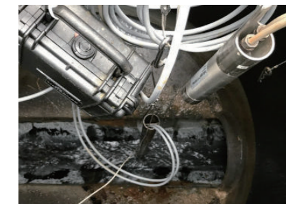
SulfiLogger™ 传感器直接在污水和其上方的空气中测量 H2S。
