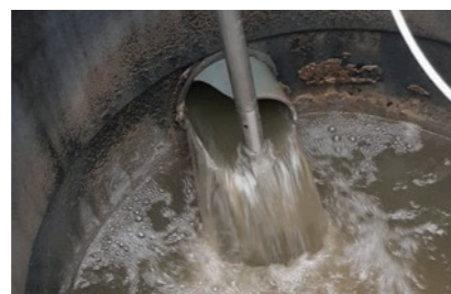
SulfiLogger™传感器直接放置在井口的原始污水中。
